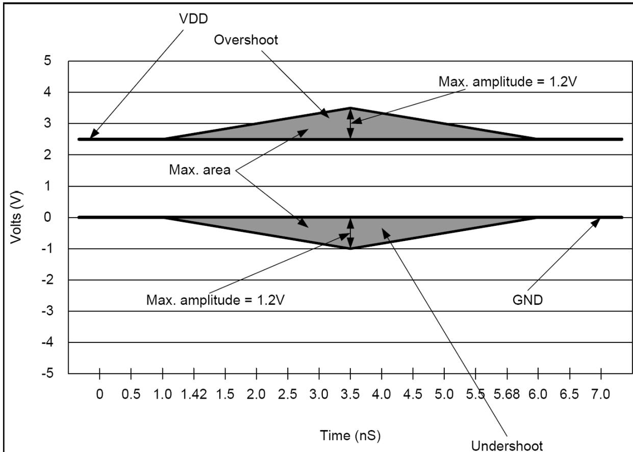
Figure 4: DQ/DM/DQS AC Overshoot and Undershoot Definition
